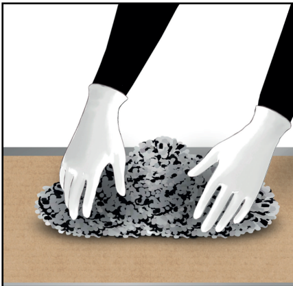
MEZCLE AMBOS COMPONENTES EN RELACIÓN 1:1
