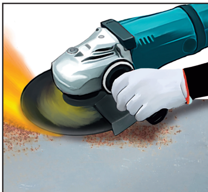
RASPE LA SUPERFICIE PARA MEJOR LA ADHESIÓN
